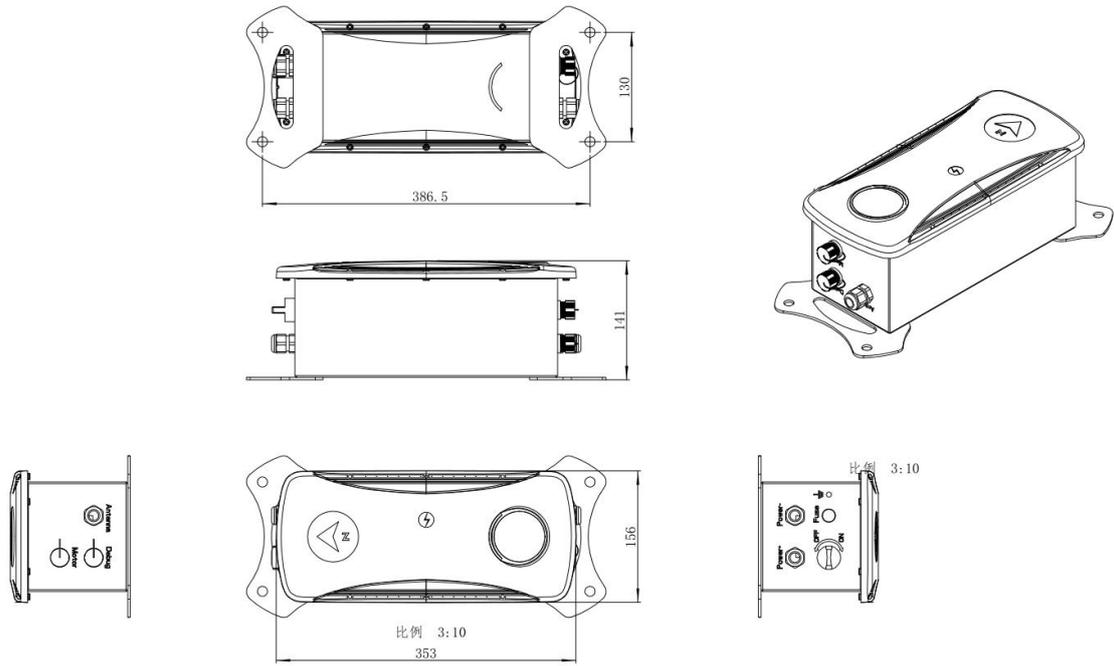
主机跟踪控制器尺寸图: 425\*191.5\*141mm
